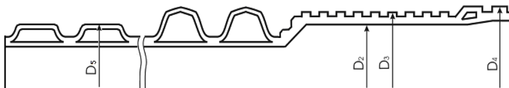
Рисунок 3 - Труба гофрированная с раструбом из полипропилена тип II (с уменьшенной высотой гофра в месте соединения с раструбом)
