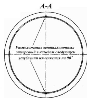
б) профиль трубы с раструбом
